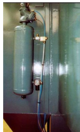
Vista laterale con particolare del sistema di scuotimento pneumatico in contropressione
