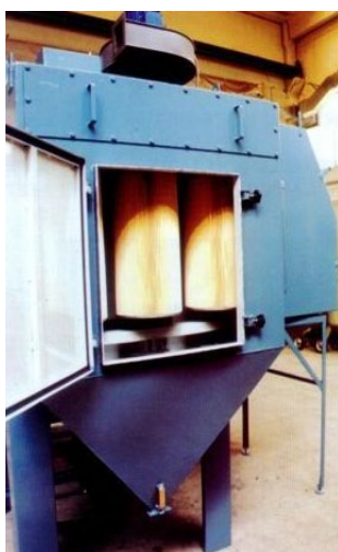
Vista posteriore con particolare del filtro a cartucce ad alto rendimento collegato direttamente al corpo macchina
