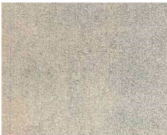
Condicion A Blasted to Sa 2,5
