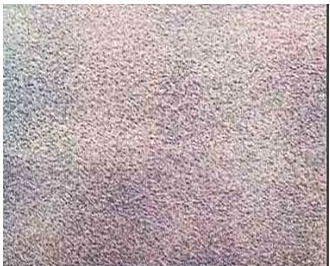
Condicion C Blasted to Sa 2
