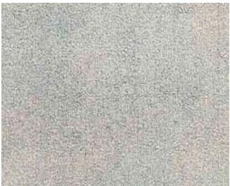
Condicion A Blasted to Sa 2
