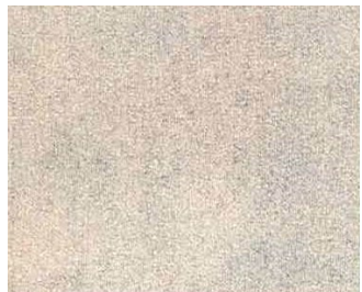
Condicion C Blasted to Sa 2,5
