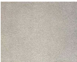
Condicion A Blasted to Sa 3
