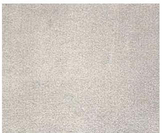
Condicion C Blasted to Sa 3
